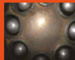
NETTOYAGE AUTOMATIQUE des turbulateurs
